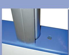
För sarg typ LA (aluminium) kan aluminiumstolparna integreras med sargent- stolpen sticks ned genom överliggaren och övre ramrör (borras). Inga verktyg behövs för glasdemonteringen då stolparna kan dras rakt upp ur sargent, en mycket bra lösning då glaset skall demonteras ofta.
